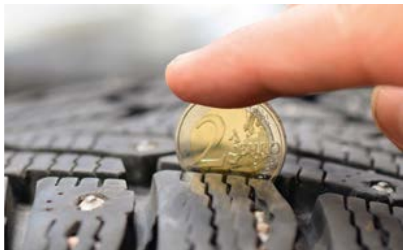
Der 2-Euro-Trick: Der silberne Ring einer 2-Euro-Münze misst genau 4 mm, mit dieser Profiltiefe fahren Sie im Winter auf Nummer sicher.
